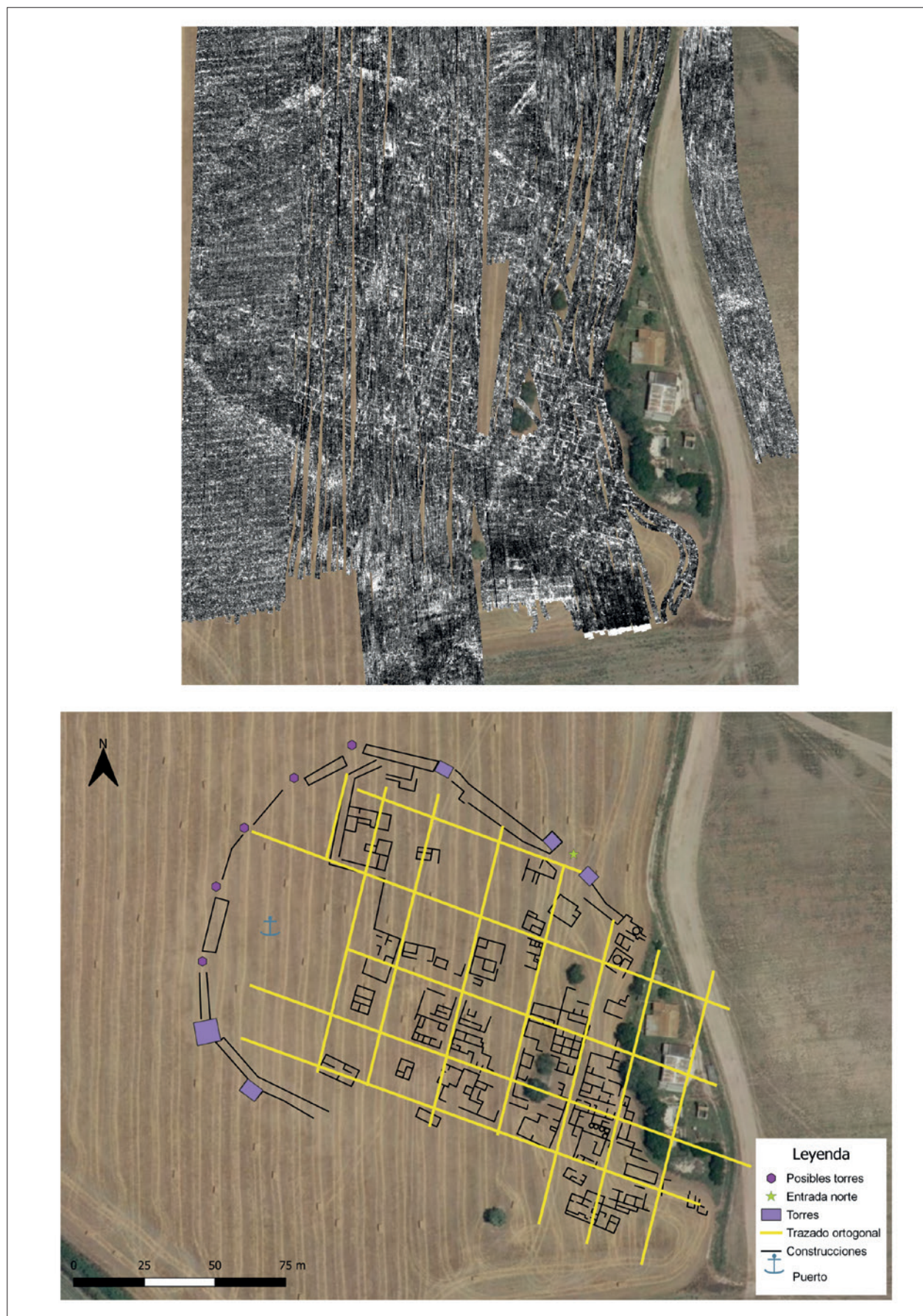
Fig. 1: Arriba: Planta del asentamiento portuario púnico de La Martela según la exploración GPR. Abajo: Representación simplificada de lo principales elementos urbanísticos del asentamiento (elaboración de los autores).
